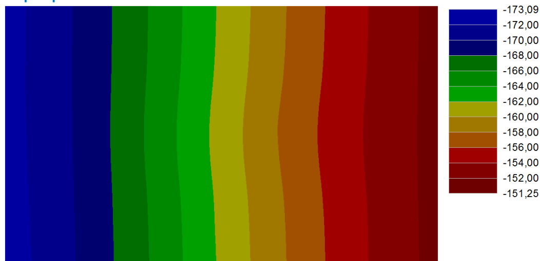
Obr. 4.4.62: Kontaktní napětí \sigma [kN/m 2 ] – KZS1: G1+G2
