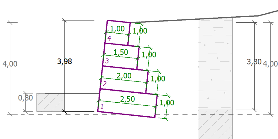
Obr. 4.3.1: Schéma geometrie konstrukce
