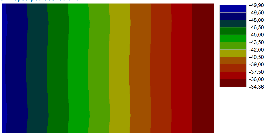
Obr. 4.5.14: Maximální kontaktní napětí \sigma [kN/m 2 ] – KZS1: Q7:G1+G2+G3
