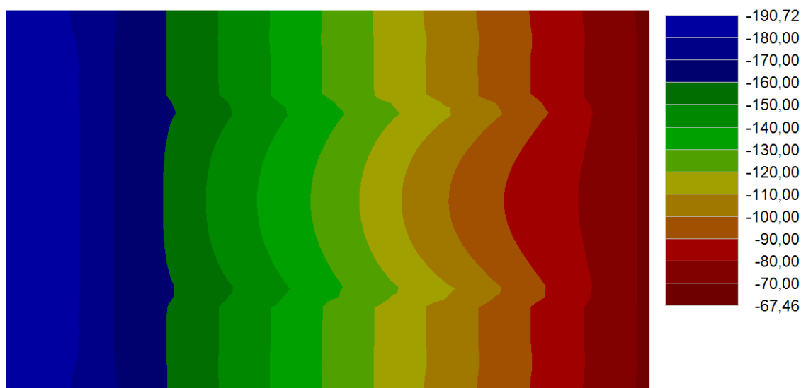
Obr. 4.4.39: Kontaktní napětí \sigma [kN/m 2 ] – extrém u zadní hrany desky (KZS3B.1: Q8:G1+G2+G3+G4+G5+G6+G7)
